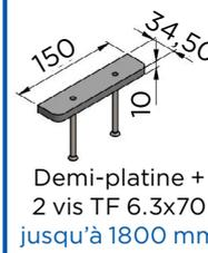
Demi-platine + 2 vis TF 6.3x70 jusqu'à 1800 mm
